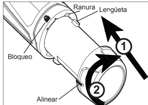
Alinee las lengüetas de la batería con las ranuras en la abertura de la herramienta. Deslice la batería por toda la longitud de la herramienta. Gire la batería en el sentido de las manecillas del reloj para trabarla en su lugar. La línea de la batería coincidirá con la cerradura de la herramienta. La herramienta no funcionará hasta que la batería no esté correctamente trabada en la herramienta.
