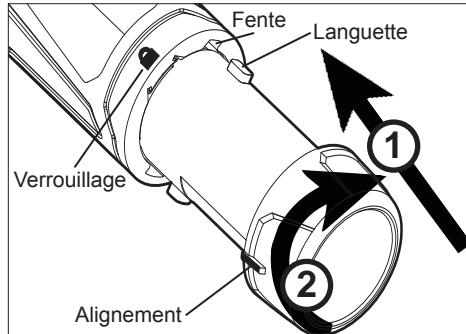
Alinez les onglets de la batterie avec les fentes de l'ouverture de l'outil. Glisser la batterie jusqu'au fond de l'outil. Tourner la batterie dans le sens des aiguilles d'une montre pour la verrouiller en place. La ligne sur la batterie s'alignera avec le cadenas de l'outil. L'outil ne fonctionnera pas si la batterie n'est pas correctement verrouillée dans l'outil.
