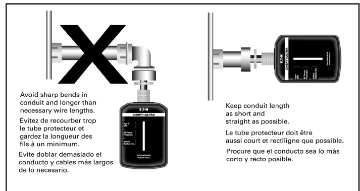
Figure 3. Conduit Installation / Installation à travers un tube protecteur / Instalación del conducto
