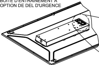
BRANCHER LE CONNECTEUR DE CONVERTISSEUR (BORNES ROUGES DE LA BOÎTE D'ENTRAÎNEMENT À DEL D'URGENCE)
