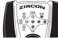
Continue deslizando el detector. Cuando el centro del barrote es localizado, la bocina sonará, y el LED indicador de centros y el señalador Spotlite® se iluminarán.
