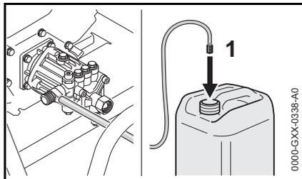
Utilice la manguera de aspiración para aspirar el detergente de un recipiente aparte. El detergente se añade al agua en la bomba de presión:
