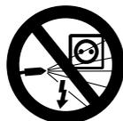
Para reducir el riesgo de cortocircuito, incendio y electrocución, no dirija el rocío hacia aparatos o equipos eléctricos, tomacorrientes o cordones eléctricos.
