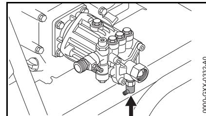
Si el motor funciona en modo de espera sin pulverizar, el agua en la bomba de alta presión se calienta hasta los 60 °C (140 °F). La válvula de seguridad deja escapar el agua caliente automáticamente de la bomba de alta presión para que ingrese agua fría al sistema.
