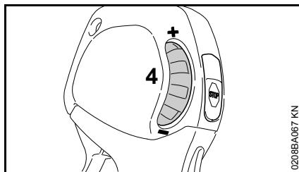
La rueda de ajuste (4) se usa para ajustar el recorrido del acelerador en una infinidad de posiciones entre marcha en vacío y aceleración máxima, regulándose así el régimen del motor:
