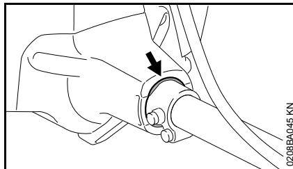
Se instala un elemento de caucho que amortigua vibraciones entre el motor y el tubo de mando. Revíselo si halla señales de desgaste o si se percibe un aumento notable en los niveles de vibración.
