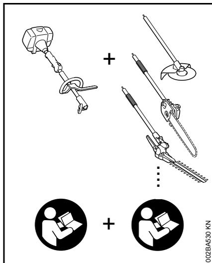
Con el sistema KombiSystem de STIHL, varios motores KombiEngine y accesorios KombiTool pueden combinarse para formar una herramienta motorizada. En este manual de instrucciones la unidad formada por el motor KombiEngine y la herramienta KombiTool se identifica como la herramienta motorizada.
