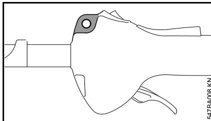
La argolla de transporte está incorporada en la parte delantera del mango de control.
