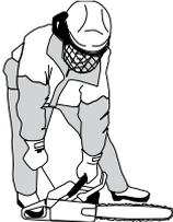
1. Poser la scie à chaîne sur une surface plane. L'accessoire de découpe ne doit pas entrer en contact avec le sol.
