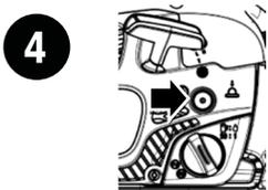
Appuyer lentement 10 fois sur la pompe d'amorçage (purge d'air).
