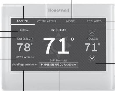
**MODE.** Sélectionnez le mode du système (chauffage, refroidissement, automatique, chauffage d'urgence).
