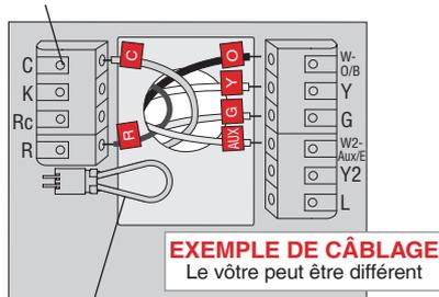
Retirez la boucle de raccordement SEULEMENT si les fils **R et Rc** sont tous les deux présents.
