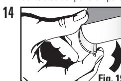
Coloque el difusor en el reborde superior. Empuje el borde ranurado hacia abajo, hacia el interior del borde inferior, hasta que quede bloqueado (Fig. 19).
