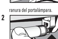
Retire el difusor tirando hacia atrás y hacia arriba de su borde superior, utilizando las puntas de los dedos (Fig. 1). Cuando reemplace una bombilla defectuosa, utilice los pulgares para presionar la bombilla y hacerla rodar 90 grados en el interior del portalámpara. Esto desacoplará las espigas de contacto de la bombilla de los contactos del portalámpara. Luego, deslice las espigas de la bombilla hacia fuera, hasta sacarlas de la ranura del portalámpara.
