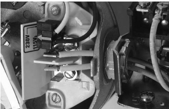
Figura 7 - Tensión configurada para 115 V, tipo ficha.
