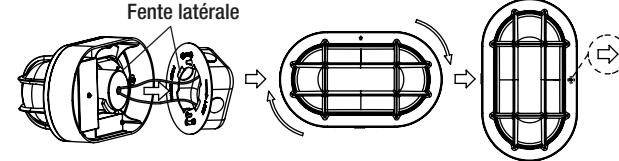
**2** Faites passer les fils chauds et neutres (noir et blanc) de la boîte de sortie électrique à travers le trou central du support de montage (AA). Alignez le support de montage (AA) à l'aide des vis de montage (BB) et serrez fermement au boîtier électrique.
