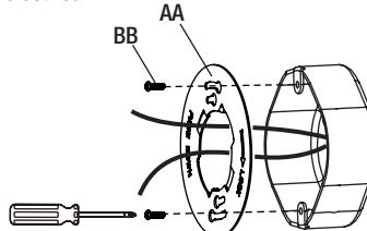
**3** Conecte los cables vivo y neutro (blanco y negro) del cuerpo del artefacto (A) a los cables del mismo color de la caja eléctrica. Cubra los conectores de cables (CC) con cinta aislante para una conexión más segura. Coloque los cables nuevamente dentro de la caja eléctrica.
