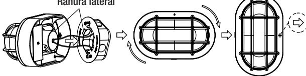
**2** Pase los cables de corriente y neutro (blanco y negro) de la caja de salida eléctrica a través del orificio central del soporte de montaje (AA). Alinee el soporte de montaje (AA) con los tornillos de montaje (BB) y apriete firmemente a la caja eléctrica.
