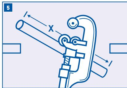
Con un cortatubos o una sierra para metales, corte y retire la sección marcada de la tubería. Lime o lije los bordes filosos en los extremos de la tubería.
