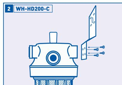
Lors de l'utilisation du support de fixation BR-C facultatif, s'assurer tout d'abord que les flèches sur le boîtier représentent bel et bien la direction de l'eau. Au besoin, retirer le support du témoin de durée de vie du filtre de l'arrière de l'unité et le placer à l'avant. Aligner les trous du support aux trous à l'arrière de la tête du filtre. Insérer quatre vis de fixation dans le support et le filtre et serrer. Sinon, passer à l'étape 3.
