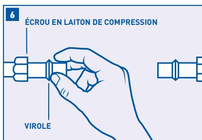
Glisser l'écrou de compression et la bague en laiton sur le bout de chaque tuyau de 1 po.
