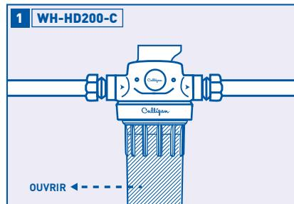
Fermer l'alimentation en tournant le robinet de dérivation de « Off » (arrêt) à « Bypass » (dérivation).
