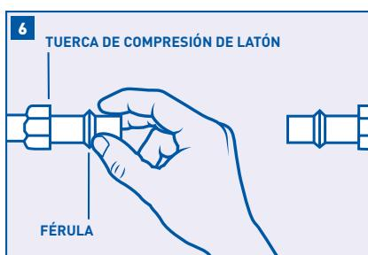
Deslice una tuerca de compresión de latón y un casquillo en cada extremo de la tubería de 1 in.
