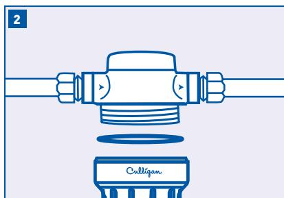
Lubrique la junta tórica con una capa de grasa de silicona limpia de grado alimenticio. Coloque la junta tórica nuevamente en la ranura y acomódela en su lugar con el dedo.
