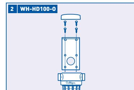
Si utiliza un soporte de montaje BR-O opcional (se vende por separado), asegúrese primero de que las flechas marcadas en el sistema coincidan con la dirección del flujo de agua. Quite la tapa del cabezal y alinee los orificios en el soporte con los orificios en el cabezal del filtro. Coloque cuatro tornillos para montaje a través del soporte y en el cabezal del filtro y ajústelos bien. Vuelva a colocar la tapa del cabezal. De lo contrario, vaya al paso 3.
