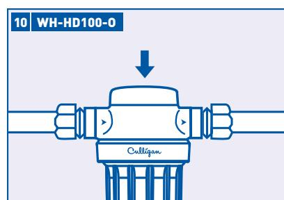
Asegúrese de que la cubierta del filtro se haya ajustado correctamente con la llave para filtro provista. Abra el suministro de agua lentamente.
