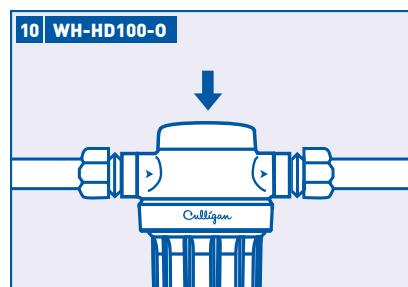
S'assurer que le boîtier est bien serré, à l'aide de la clé à boîtier fournie. Lentement rétablir l'alimentation d'eau.
