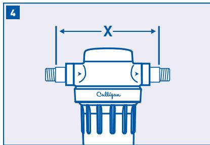
Mesurer la longueur totale du système configuré avec les adaptateurs attachés.
