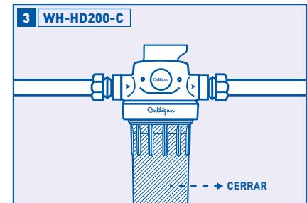
Atornille la parte inferior de la cubierta a la tapa y ajuste con firmeza. **NO AJUSTE DEMASIADO.** Asegúrese de que el tubo vertical en el cabezal del filtro se deslice dentro del cartucho.
