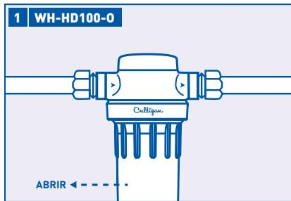
Corte el suministro de agua que pasa por el filtro. Presione el botón rojo de liberación de presión para liberar la presión. Desatornille la parte inferior de la cubierta. Quite la junta tórica de la ranura en la cubierta, límpielo y déjela a un lado. Deseche el cartucho usado.
