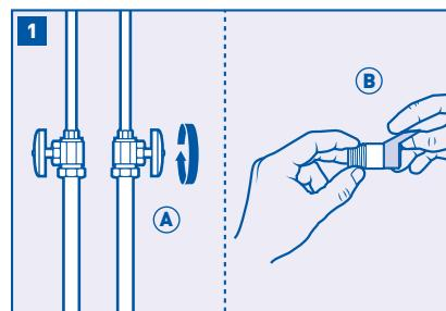
Fermer l'alimentation d'eau (A) et ouvrir le robinet le plus près afin de vidanger les tuyaux avant l'installation. Appliquer 6 po de ruban Teflon<sup>MD</sup> (B) sur le filetage des tuyaux, dans le sens horaire, pour chaque raccord.
