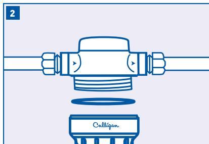
Lubrifier le joint d'étanchéité à l'aide d'une petite quantité de graisse silicone de qualité alimentaire. Insérer le joint d'étanchéité dans la rainure et l'enfoncer à l'aide des doigts.
