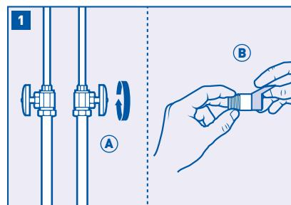
Corte el suministro de agua (A) y abra el grifo más cercano para drenar las tuberías antes de comenzar con la instalación. Envuelva las roscas de cada adaptador con, aproximadamente, 6 in de cinta de Teflón® (B) en el sentido de las agujas del reloj.
