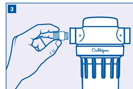
Ensamble todos los accesorios. Coloque manualmente los adaptadores (no incluidos) en el cabezal del filtro. Utilice una llave para ajustarlos bien.
