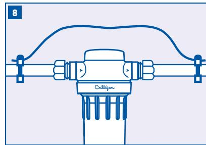
**PRECAUCIÓN:** Si se utilizan tuberías de agua para conectar a tierra sistemas eléctricos, electrodomésticos o teléfonos, asegúrese de instalar un cable de puente.
