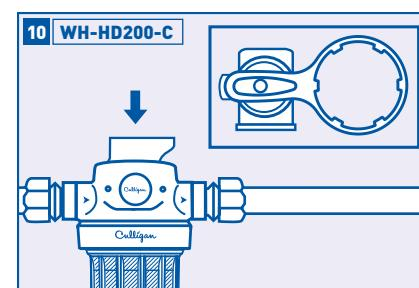
Asegúrese de que la cubierta del filtro se haya ajustado correctamente con la llave para filtro provista.
