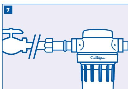
Alinee el ensamblaje del filtro con los extremos de la tubería y asegúrese de que el flujo de agua corra en la misma dirección que las flechas en el cabezal del filtro. Será necesario que separe los extremos de la tubería para instalar el ensamblaje del filtro. Utilice dos llaves inglesas; con una de ellas, sujeté bien el accesorio entrante y, con la otra, ajuste la tuerca. Repita el proceso con el accesorio saliente.
