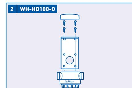
Lors de l'utilisation du support de fixation BR-O facultatif (vendu séparément), s'assurer tout d'abord que les flèches sur le boîtier représentent bel et bien la direction de l'eau. Retirer le couvercle et aligner les trous du support de fixation avec les trous de la tête du filtre. Insérer quatre vis de fixation dans le support et le filtre et serrer. Replacer le couvercle. Sinon, passer à l'étape 3.
