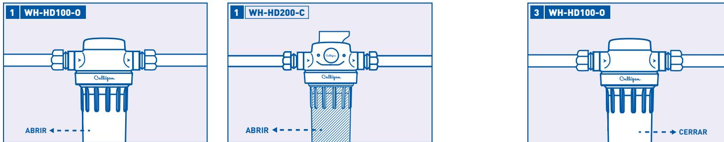
Atornille la parte inferior de la cubierta a la tapa y ajuste con firmeza. **NO AJUSTE DEMASIADO.** Asegúrese de que el tubo vertical en el cabezal del filtro se deslice dentro del cartucho.
