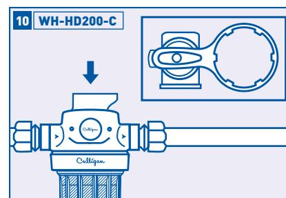
S'assurer que le boîtier est bien serré, à l'aide de la clé à boîtier fournie. Ouvrir le robinet de dérivation au mode « Filter » (filtre) et rétablir l'alimentation d'eau principale.
