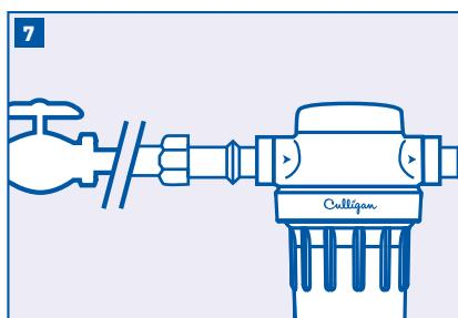
Aligner le filtre assemblé et les bouts des tuyaux, en s'assurant que la direction de l'écoulement d'eau correspond à la direction des flèches sur la tête du filtre. Il est nécessaire d'écartier les tuyaux pour installer le filtre assemblé correctement. À l'aide de deux clés à molette, retenir fermement le raccord d'entrée d'une clé et serrer l'écrou de l'autre. Répéter le processus avec le raccord de sortie.
