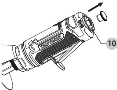
2. Apriete el conector macho (no se incluye) girando en dirección de las manecillas del reloj con una llave (no se incluye) para una conexión hermética.
