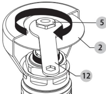
6. Inserte el perno de la llave hexagonal **4** en el husillo **9** y, con la llave hexagonal **13**, gire el perno en dirección contraria a las manecillas del reloj para apretar. NO APRIETE DEMASIADO.
