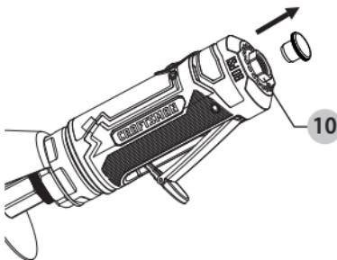
2. Serrez le connecteur mâle (non inclus) en le tournant dans le sens des aiguilles d'une montre à l'aide d'une clé (non incluse), afin que le raccord soit étanche à l'air.
