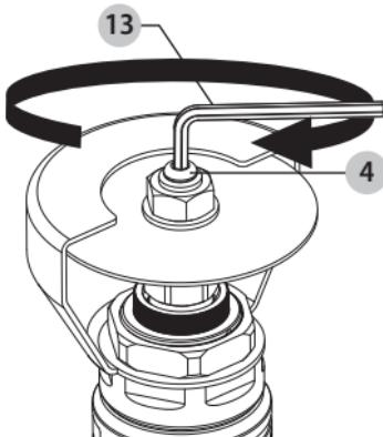
3. A l'aide de la clé fournie **12**, desserrez et retirez l'écrou hexagonal **5** en le tournant dans le sens inverse des aiguilles d'une montre, retirez l'écrou et la rondelle, puis retirez le disque de coupe **2**.
