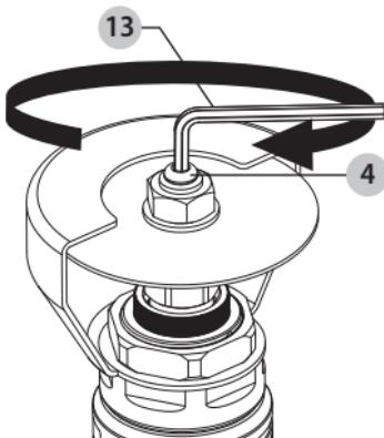
3. Con la llave inglesa **12** proporcionada, suelte y retire la tuerca hexagonal **5** girándola en dirección contraria a las manecillas del reloj, retire la tuerca y la arandela, luego retire el disco de corte **2**.
