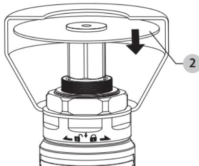
5. Coloque la arandela en la parte superior del disco de corte **2**. Enrosque la tuerca hexagonal **5** con la mano girándola en dirección de las manecillas del reloj. Use la llave inglesa **12** para apretar.
