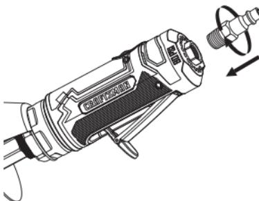
3. Versez 2 ou 3 gouttes d'huile à outil pneumatique (non incluse) dans l'ouverture du connecteur mâle avant chaque utilisation.
