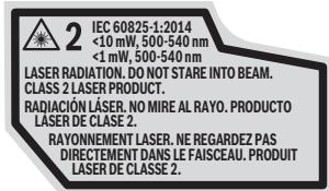
**NO retire ni desigure ninguna etiqueta de advertencia o de precaución.** Si se retiran las etiquetas, se aumenta el riesgo de exposición a radiación láser.
