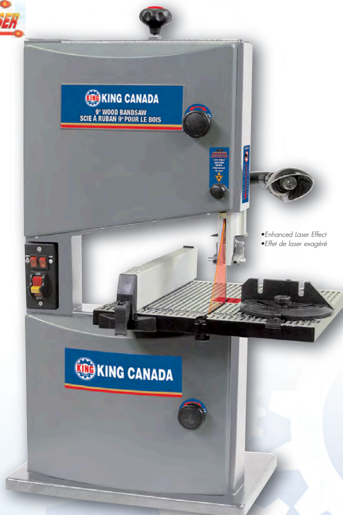
Manivelle d'ajustement à crémaillère de la hauteur de coupe
