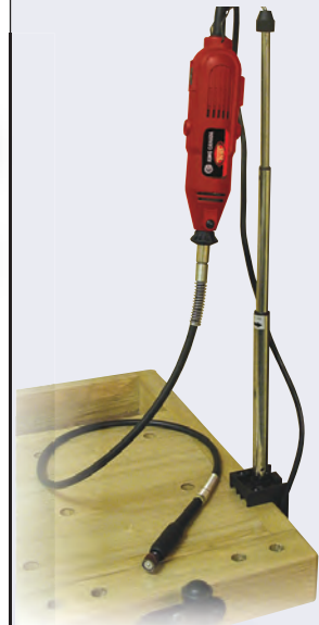
Arbre flexible de 40" et support ajustable
