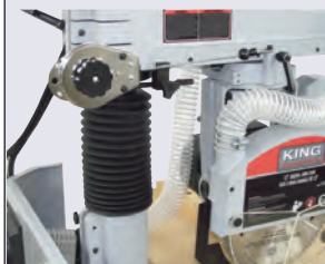
Ressort de retour réglable rétracte le moteur et le chariot
