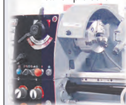
Système d'interrupteur à ouverture forcée et garde de sécurité protégé par interrupteur de fin de course
