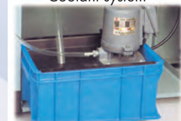
Système de refroidissement
