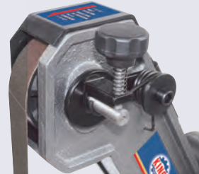
Système de réglage du pistage et tension de la courroie
