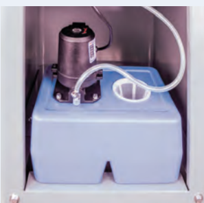
Système de liquide de refroidissement avec réservoir à volume élevé de 5 gallons
