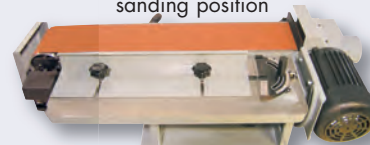
La table est illustrée dans la position de ponçage horizontale
